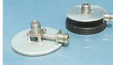
Links de magneetvoet met een magneet uit een floppy diskdrive, rechts de omgebouwde magneetvoet van de Traxis antenne.
